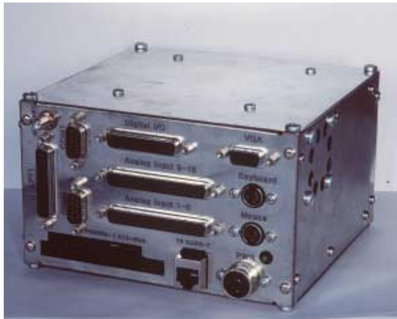
**Abbildung 12: Flugmessanlage FMA-PC III für Segelflugzeuge**
